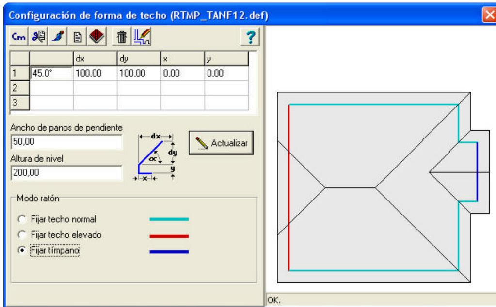
En el campo de definición, el programa define toda una serie de secciones en una línea mostrada en el icono. El icono muestra una sección transversal del tejado como si la viera paralela con la pared.
